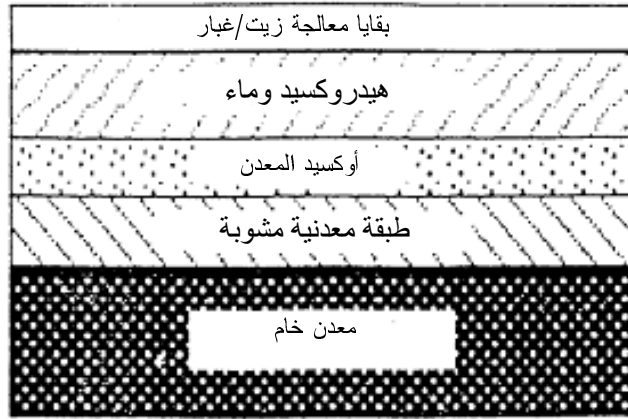
الشكل (1، 23): مقطع تقريبي لسطح ركيزة [10].
